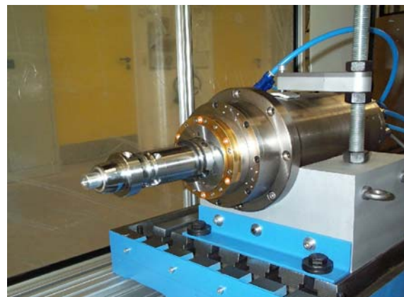
Bild 1: Spindelprüfstand mit HSC-Motorspindel für die innere Aerosolzufuhr
