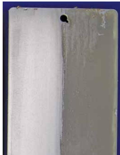
Links abgereinigter Wachsfilm, rechts CPX™-Schutzfilm nach 1.000 Stunden Salzsprühkammerprüfung
